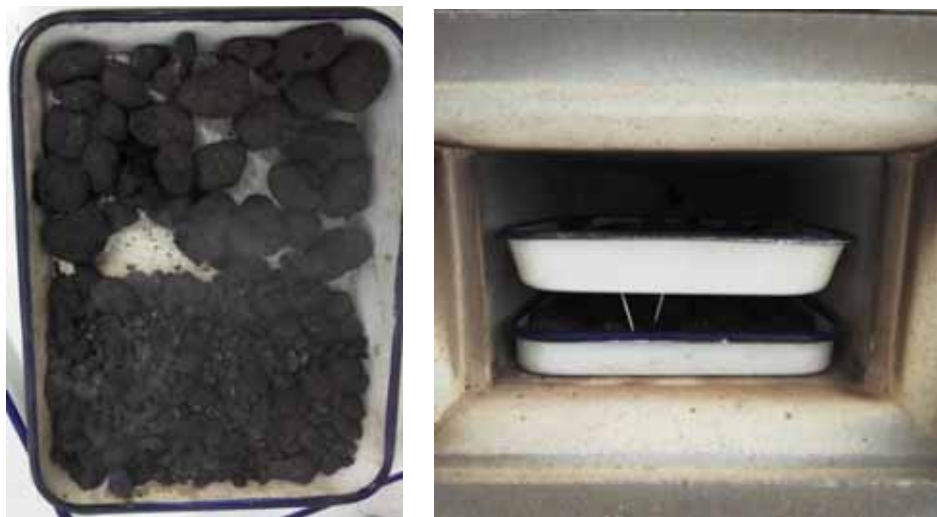
图 5.3 热脱附小试试验照片
