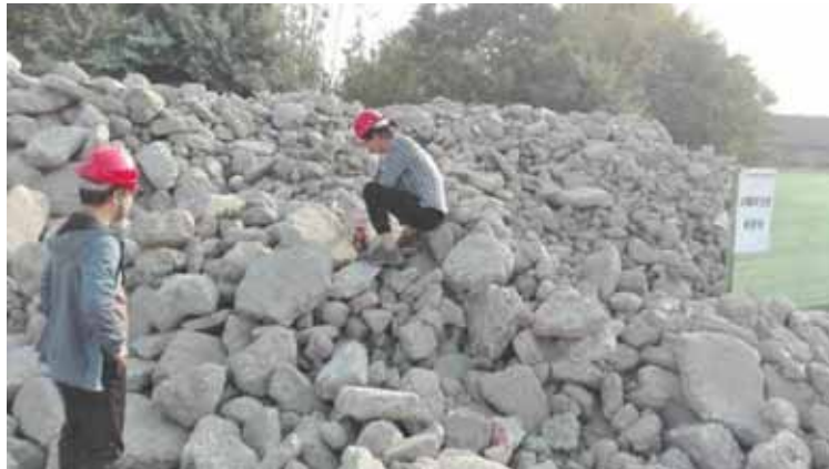
图 6.19 冲洗后的渣土
